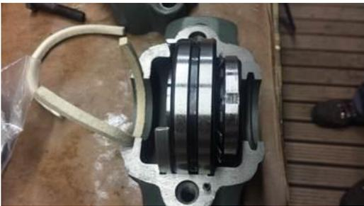
5. Mit einem Cutter oder einer Schere den Filz bündig / mit 1mm Überstand an der gefrästen Fläche abschneiden. Auf allen Seiten/Flächen wiederholen.
